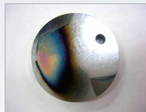
自動車エンジン用のシム上に堆積させたUNCDD膜(潤滑用硬質皮膜)
